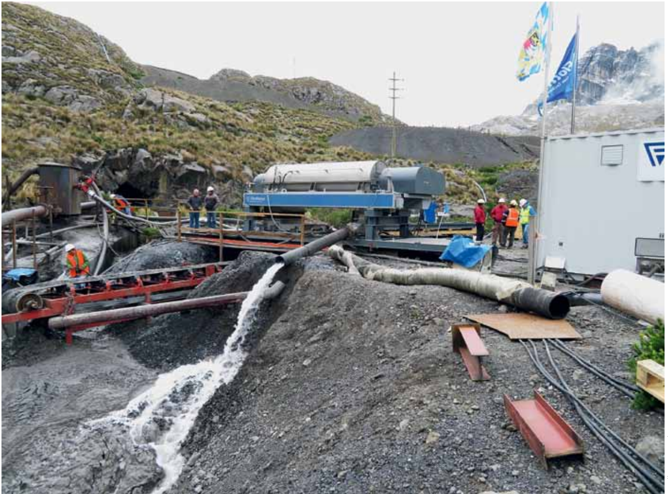
1 Flottweg Versuchsanlage bei Testfahrten in Südamerika • Flottweg Decanter during a test run in South America
