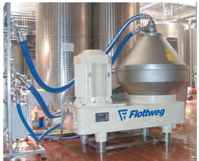
FLOTTWEG SEPARATOR Typ AC2500 zur Klärung von Fruchtsaft und Fruchtwein
