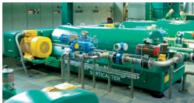
FLOTTWEG SORTICANTER® Typ K6E für das Recycling von Kunststoffen
