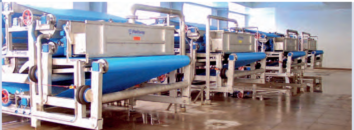
FLOTTWEG BANDPRESSEN zur Gewinnung von Apfelsaft
