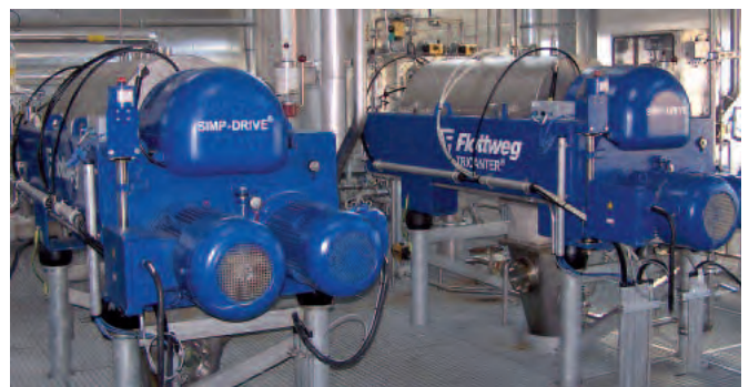
FLOTTWEG TRICANTER® Typ Z4E zur Aufbereitung von ölhaltigen Schlämmen
