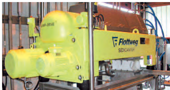
FLOTTWEG SEDICANTER® Typ S3E zur Bierrückgewinnung
