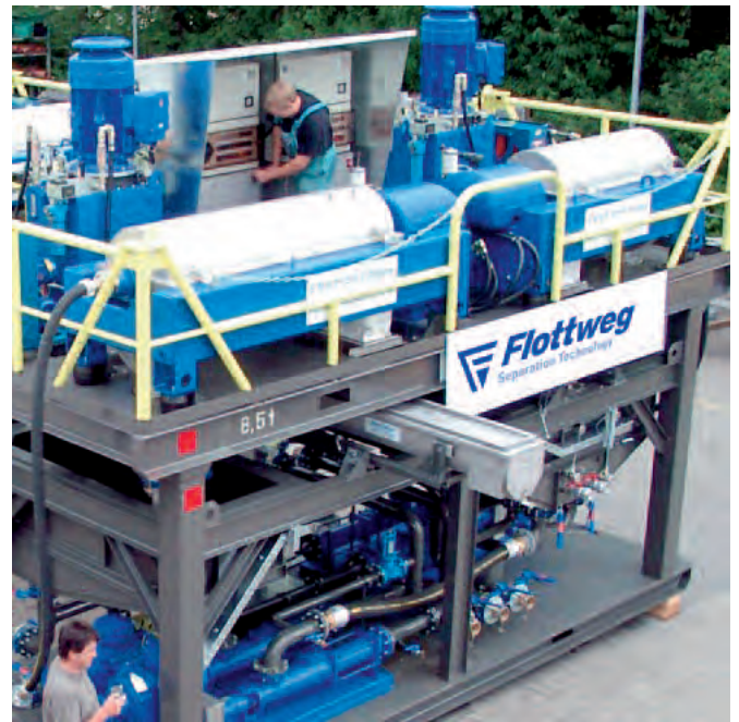
FLOTTWEG SYSTEM zur Aufbereitung von Bohrspülung
