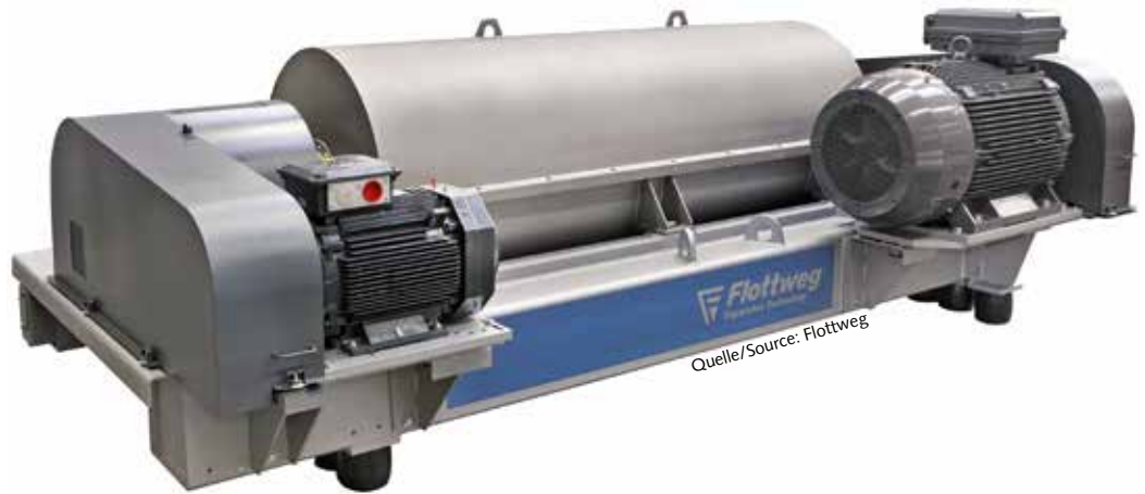
5 Flottweg Dekanter zur Aufbereitung von Tailings • Flottweg Z92 Decanter for tailings processing
