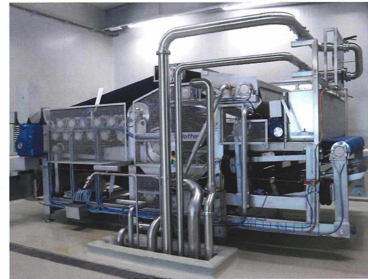
Die Flottweg Bandpressen sind nach der Waschung, Vorsortierung und Zerkleinerung der Äpfel die zentrale Einheit für die Saftgewinnung.
