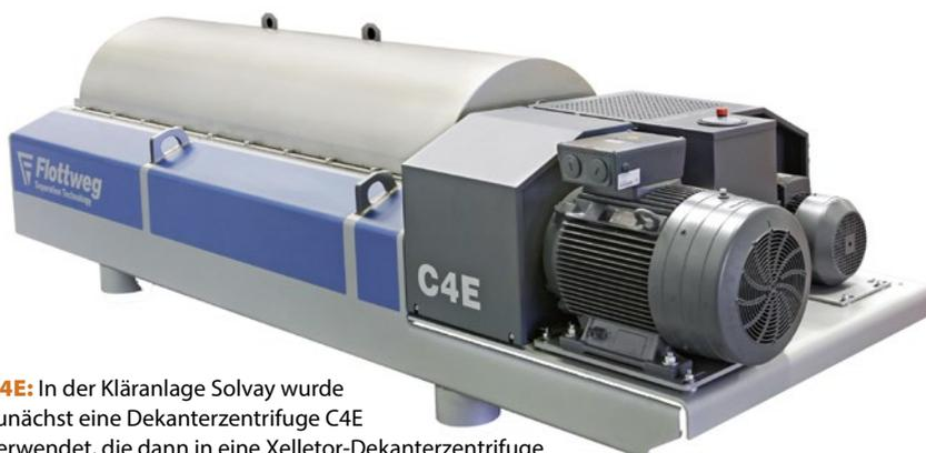
**C4E:** In der Kläranlage Solvay wurde zunächst eine Dekanterzentrifuge C4E verwendet, die dann in eine Xelletor-Dekanterzentrifuge X4E getauscht wurde. Hierbei musste lediglich die rotierende Einheit gewechselt werden.
