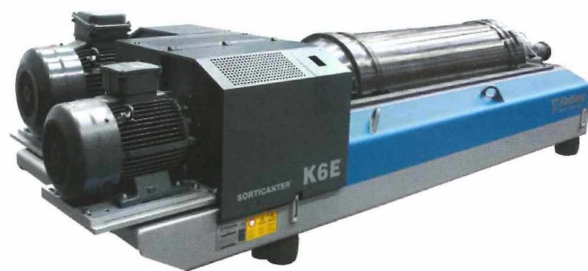
Bild 1: Durch die Trennung verschiedener Kunststoffarten sorgt der patentierte Flottweg Sorticanter® für wirtschaftliches Recycling.
