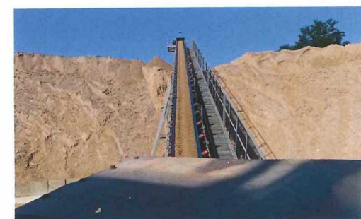
Das entwässerte Material verlässt die Maschine so trocken, dass ein Abtransport problemlos möglich ist.
