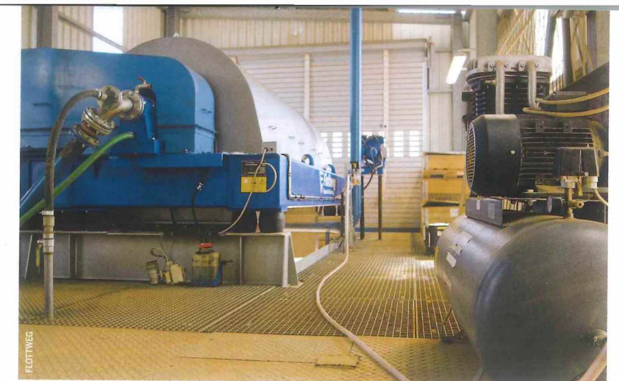
Die Dekanterzentrifuge Z92 von Flottweg verarbeitet bis zu 15 t/h des Materials.
