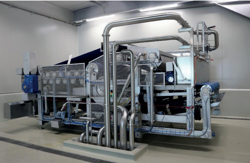
Die Flottweg Bandpressen sind nach der Waschung, Vorsortierung und Zerkleinerung der Äpfel die zentrale Einheit für die Saftgewinnung
