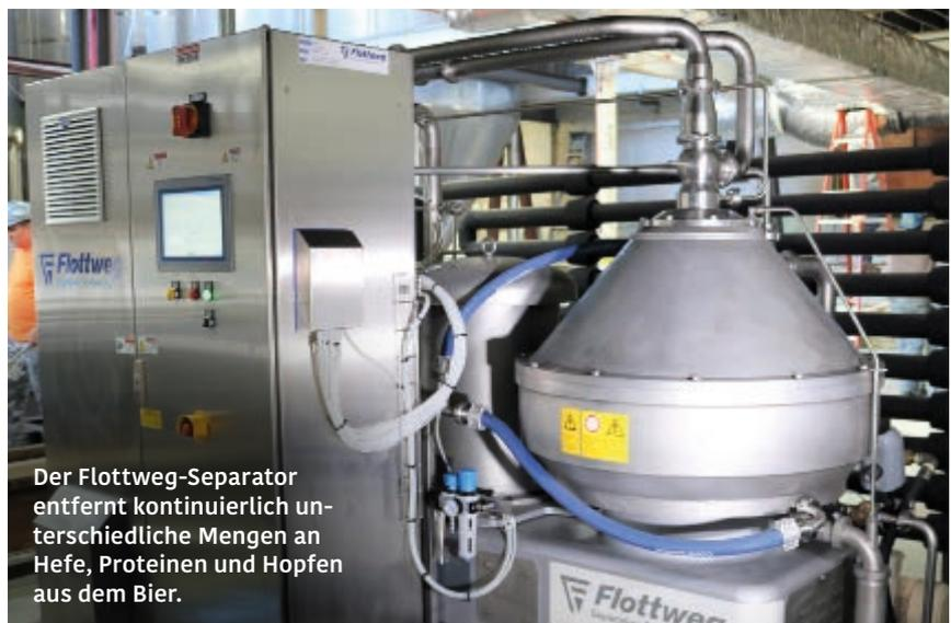
Der Flottweg-Separator entfernt kontinuierlich unterschiedliche Mengen an Hefe, Proteinen und Hopfen aus dem Bier.
