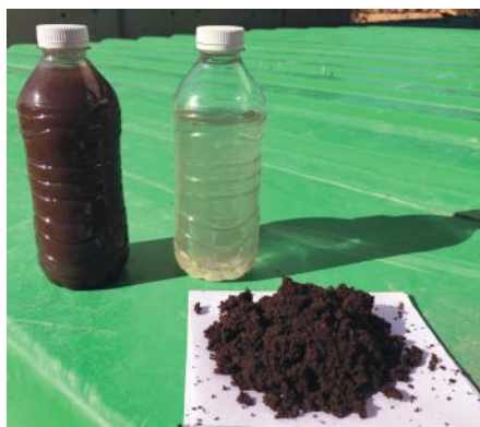
Abbildung 1: Links: Schlamm vor der Entwässerung; Rechts: Flüssigphase nach der Zentrifuge sowie ausgetragener Feststoff (Abbildung: Flottweg)
