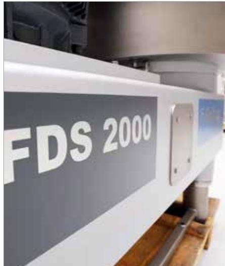
Der Düsenseparator kann zur kontinuierlichen Abscheidung von Feststoffen aus Flüssigkeiten eingesetzt werden.
