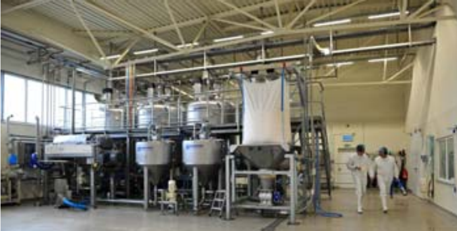
Blick auf die komplette Anlage zur Verarbeitung von Lupinensamen. Links im Bild der Flottweg-Sedicanter, der die Vorteile von Separator und Dekanter in einer Anlage kombiniert.
