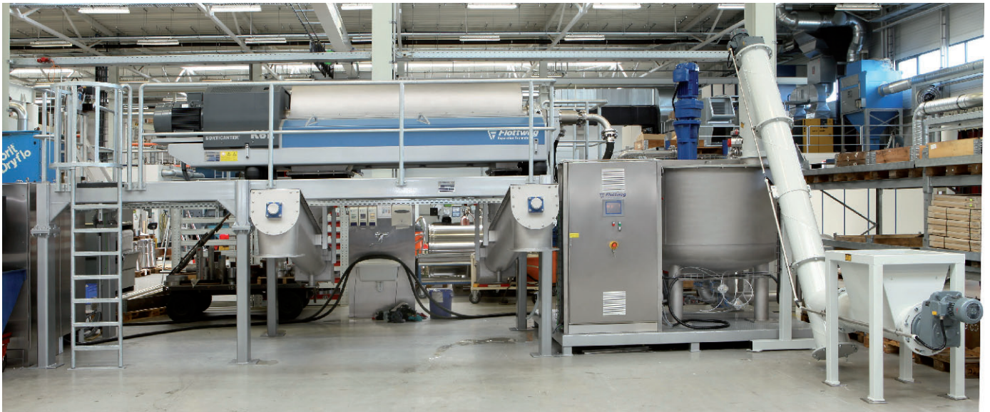
Flottweg Sorticanter mit Feststoffaustrag schwere Phase, leichte Phase, Anmischbehälter und Dosierung
