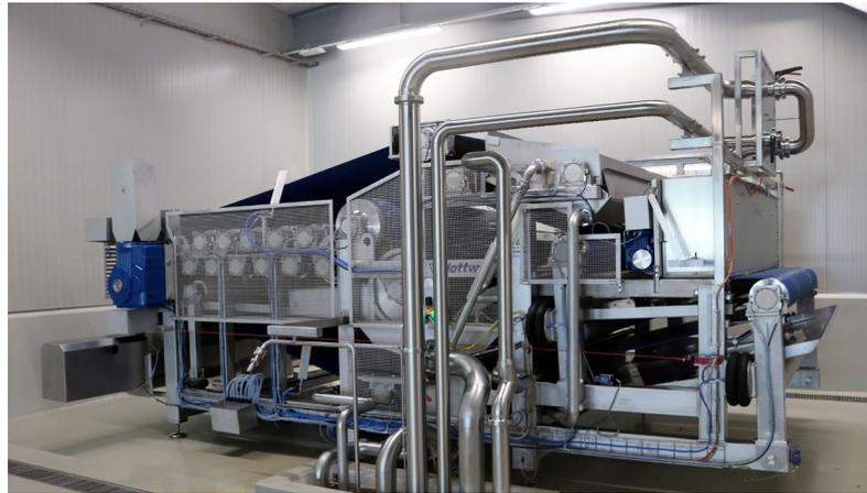
Les presses à bandes Flottweg sont l'élément central pour l'extraction.
