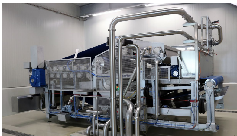
Prasy taśmowe marki Flottweg stanowią centralną jednostkę do ekstrakcji soku.
