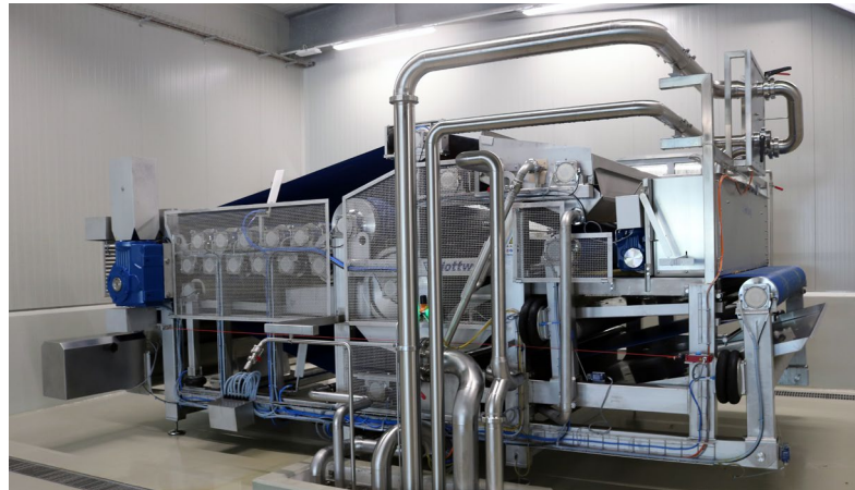
As prensas de correia da Flottweg formam a unidade central para extração de suco.
