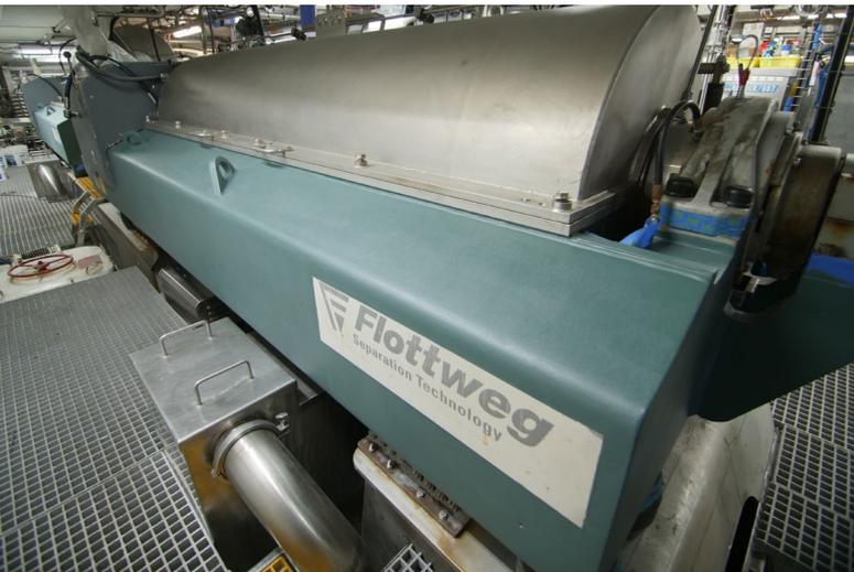
A bordo do Starbound, o equipamento da Flottweg é usado para separar a carne do líquido.
