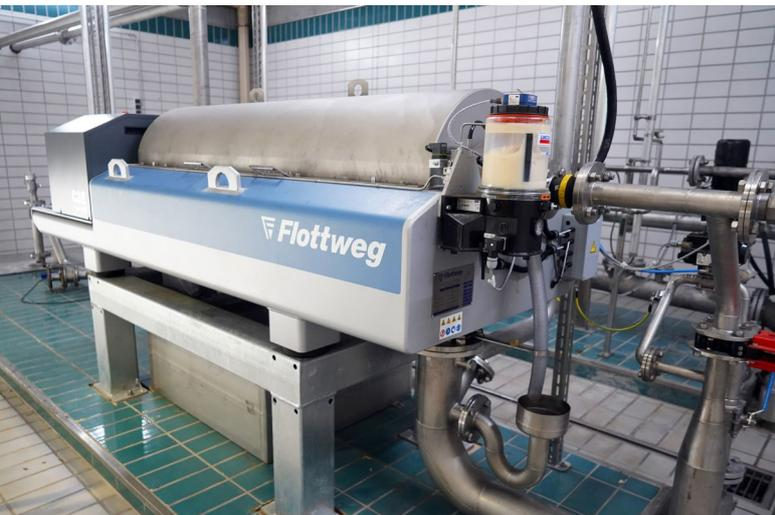
schlammes erhöht, was im Faulturm zu konstanten Verhältnissen hinsichtlich Feststoffgehalt und Faulzeit führt. Mit Hilfe des Flottweg Dekanters wurde der Trockenstoffgehalt des Überschussschlammes auf 6 bis 7 % konzentriert, wodurch sich auch die Gasausbeute verbessert hat. Mehr Biogas bedeutet folglich, dass im Blockheizkraftwerk des Abwasserverbands noch mehr Strom und Wärme erzeugt werden können, die wiederum den komplett energieautarken Betrieb des Klärwerks möglich machen.
