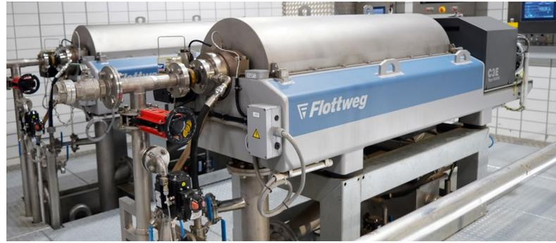
Para deshidratar los lodos, la Asociación de Aguas Residuales utiliza dos centrifugas HTS C3E.
