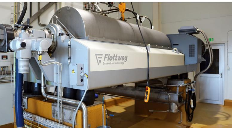
Le centrifughe industriali e le presse a nastro prodotte da Flottweg estraggono amido, fibre e proteine dalle patate.
