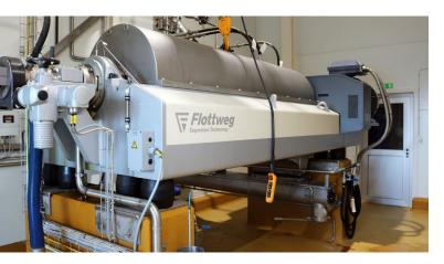
As centrífugas industriais e prensas de correia da Flottweg extraem amido, fibra e proteína das batatas.
