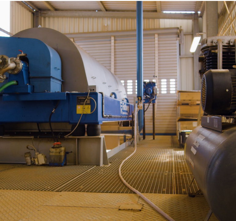
Wirówka dekantacyjna Z92 marki Flottweg umożliwia przetwarzanie do 15 ton materiału na godzinę.
