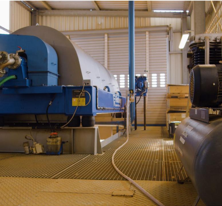
A centrífuga decantadora Z92 da Flottweg processa até 15 toneladas de material por hora.
