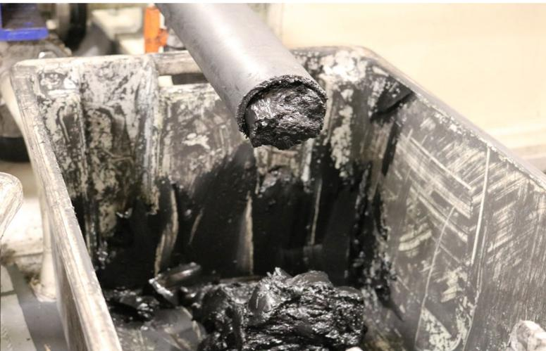
Der entwässerte Schlamm wird in kleinen Containern zwischengelagert und anschließend auf dem Festland entsorgt.
