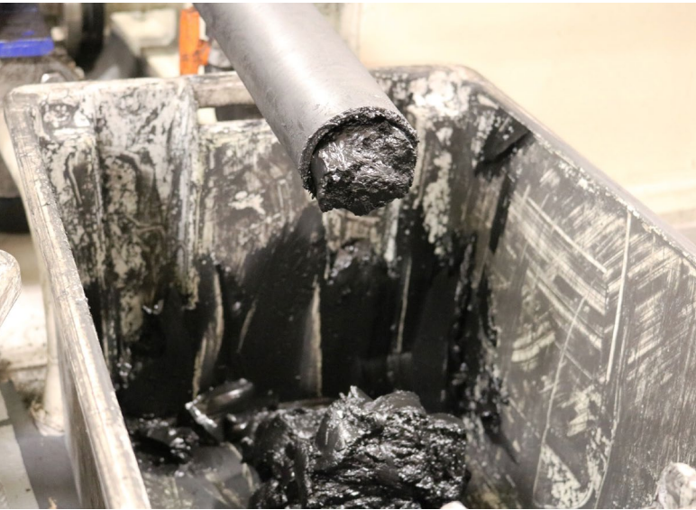
I fanghi disidratati vengono temporaneamente stoccati in piccoli contenitori e quindi smaltiti correttamente sulla terraferma.
