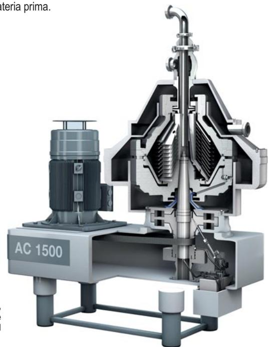
Centrífuga de Discos Flottweg, modelo AC 1500 para la elaboración de aceite de aguacate (palta) de alta calidad
