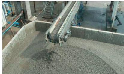
Descarga de sólidos después del procesamiento utilizando un Decanter Flottweg
