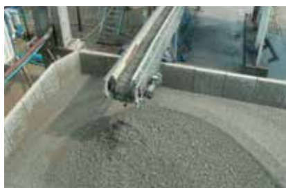
Выгрузка твердой фазы после декантера Flottweg
