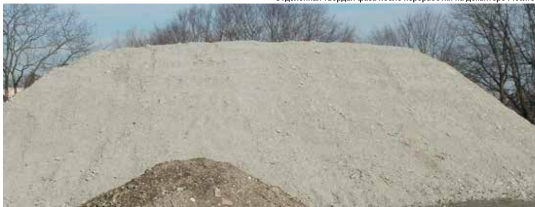
Отделённая твёрдая фаза после переработки на декантере Flottweg
