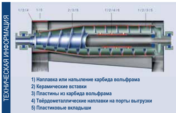
Съёмные износостойкие элементы, заменяемые на месте
