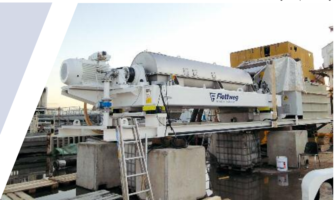
Décanteur Flottweg dans un procédé de forage
