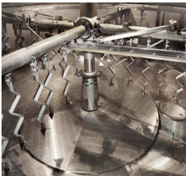
Młóto – z kadzi do klarowania bezpośrednio do prasy taśmowej Flottweg
