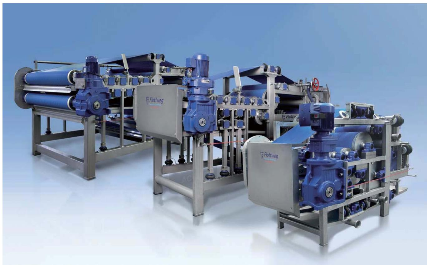
带式压滤机 用于废麦糟脱水
