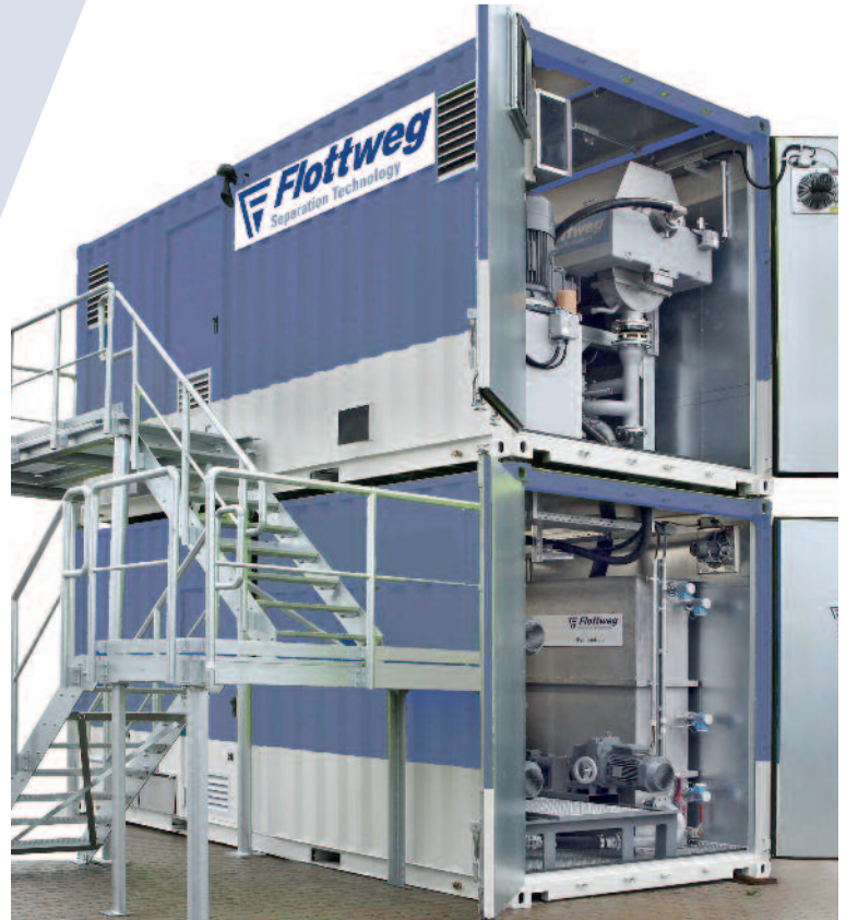
Containeranlagen für die Aufbereitung von Bohrschlamm
