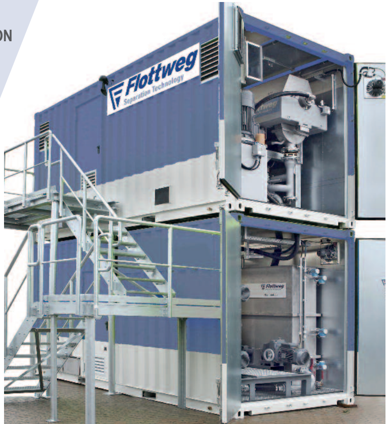
Sistema con contenedor para el procesamiento de lodos de perforación
