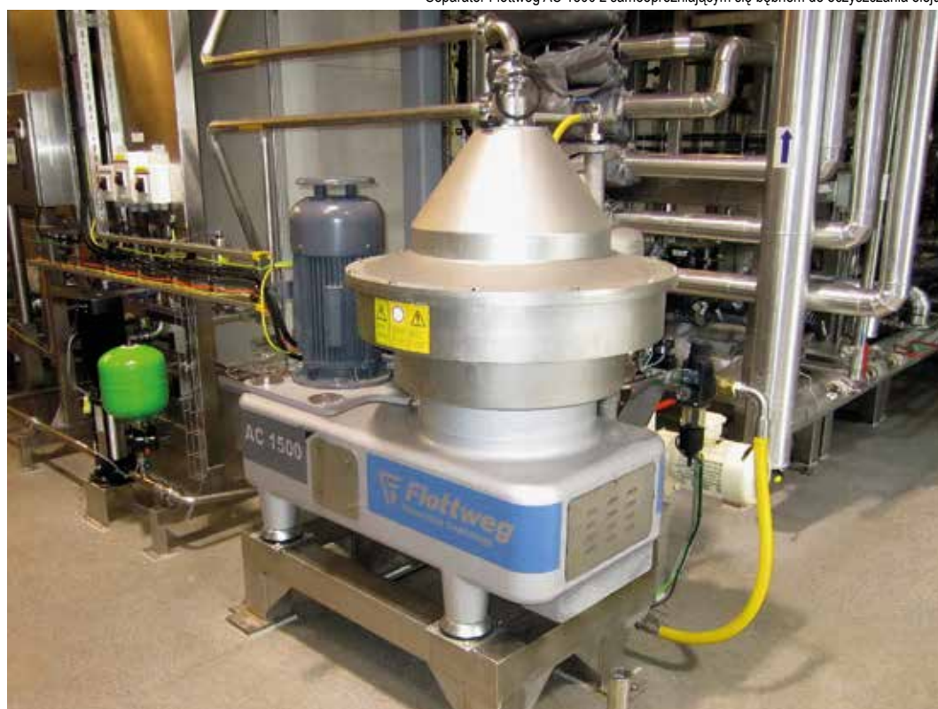
Separator Flottweg AC 1500 z samoopróżniającym się bębnem do oczyszczania oleju.
