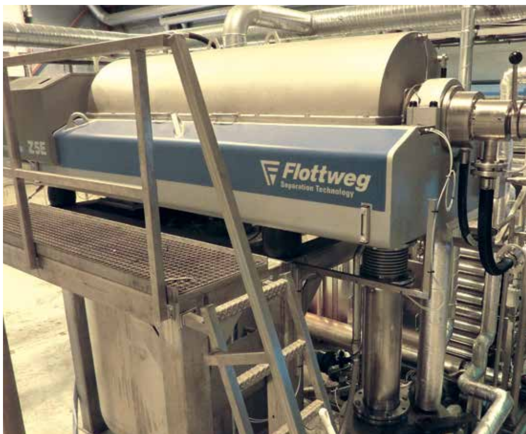
Wirówka Flottweg Tricanter® Z5E w norweskich zakładach kiszonki rybnej, surowiec klasy 2.
