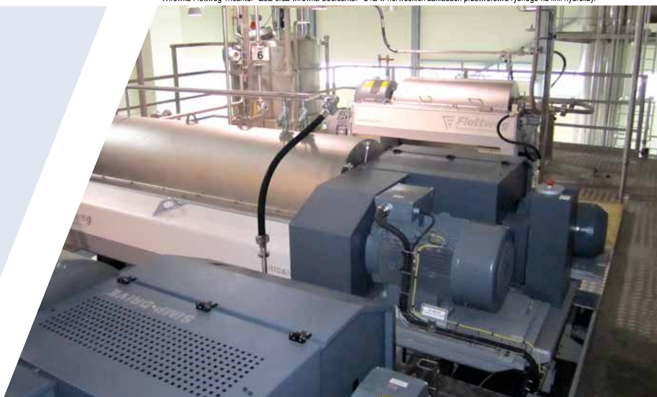
Wirówka Flottweg Tricanter® Z5E oraz wirówka Sedicanter® S4E w norweskich zakładach przetwórstwa rybnego na linii hydrolizy.
