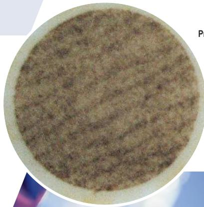
Prova a filtro per analizzare l'efficienza di separazione della Centrifuga a Dischi Flottweg
