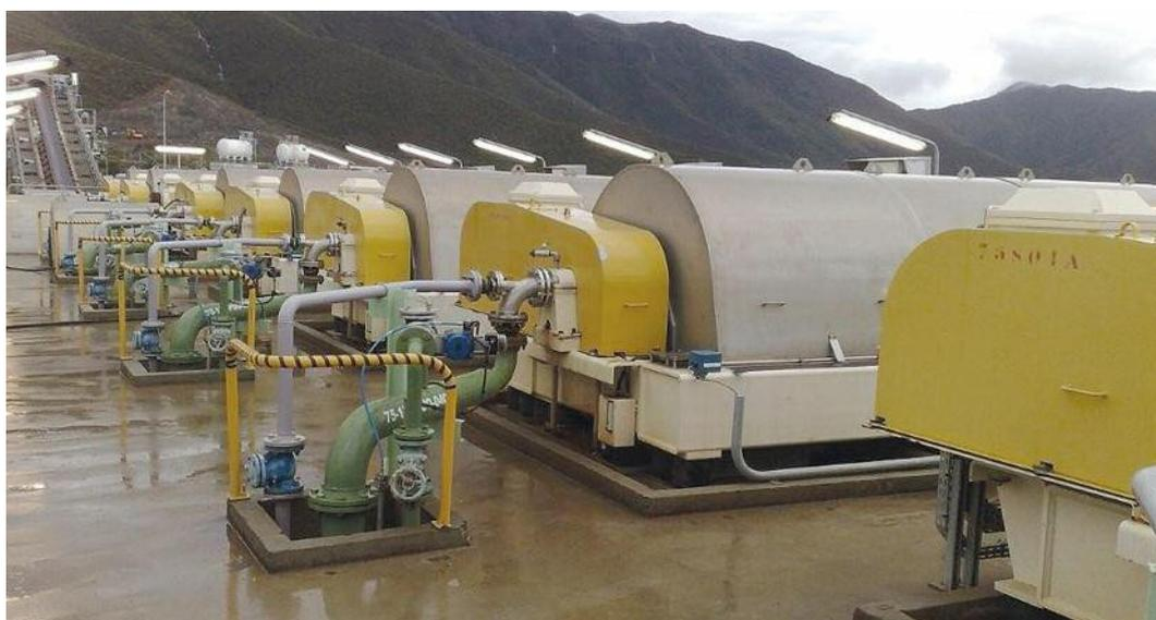
Decantadoras Flottweg, modelo Z92 en el proceso de extracción de níquel
