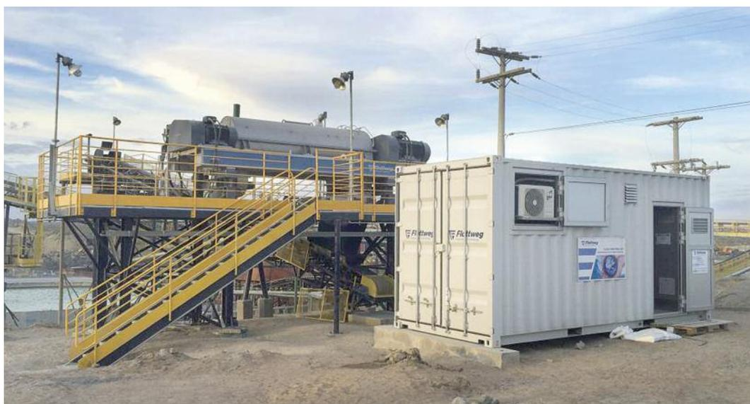
Sistema Flottweg, incluyendo una decantadora Z92, en el proceso de extracción de diamantes
