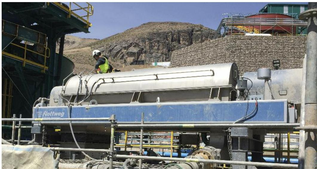
Sistema Flottweg, incluyendo una decantadora Z92, en el proceso de extracción de oro
