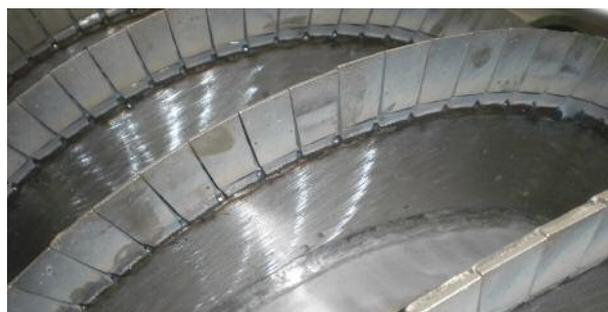
Protección del tornillo sinfín utilizando metales duros
