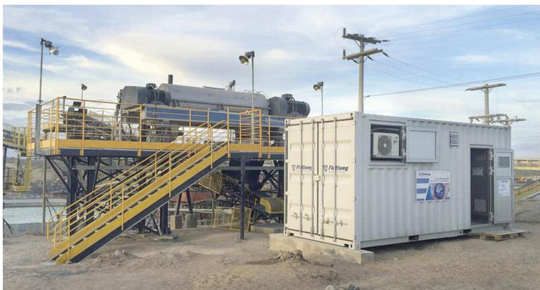
Flottweg Decanters Z92 no processamento de rejeitos da mina de diamante
