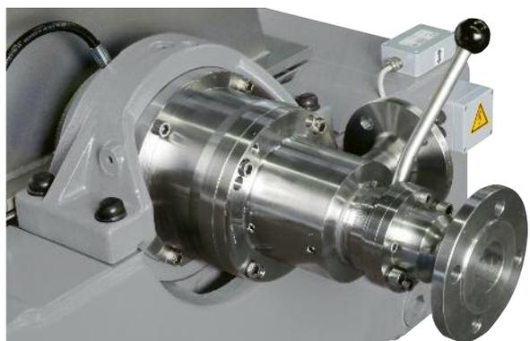
Dispositivos de alimentação e descarga com alavanca de controle para o impulsor ajustável do Tricanter® Flottweg
