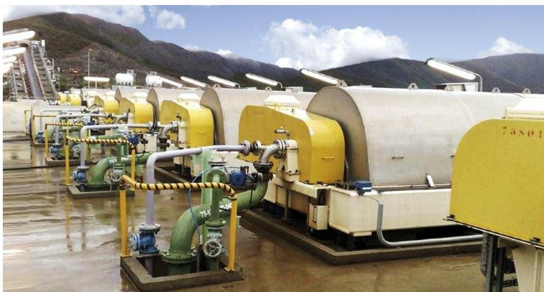
Flottweg Decanters Z92 no processo de extração de níquel
