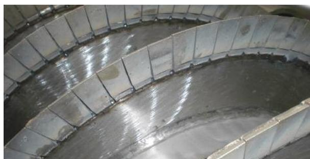
Proteção da rosca transportadora com pastilhas de metal duro
