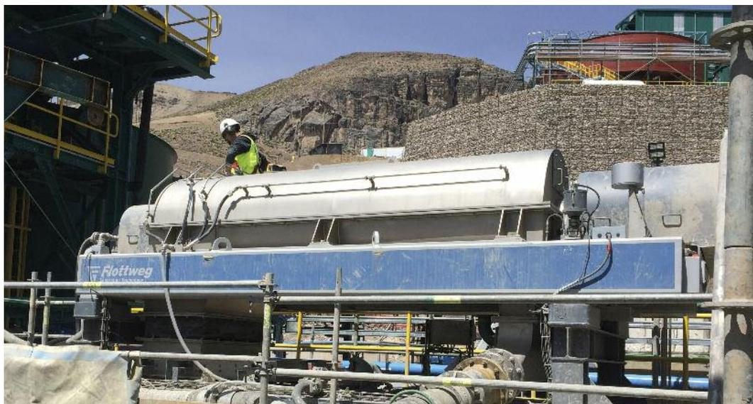
Flottweg Decanters Z92 no processamento de rejeitos da mina de ouro
