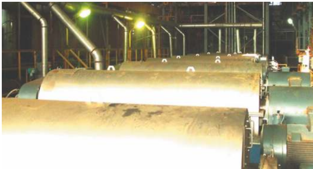
ДЕКАНТЕРЫ Z92 FLOTTWEG, используемые при добыче золота в России
