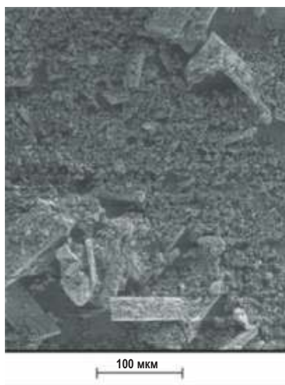
Обращайте особое внимание на качество Вашего конечного продукта — анализ цинксоодержащего осадка (электронный микроскоп)
