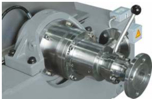
Устройства подачи и отвода продукта оснащены рычагами, которые осуществляют управление импеллером FLOTTWEG TRICANTER®.
