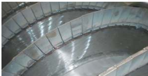
Защита шнека твердосплавными пластинами
