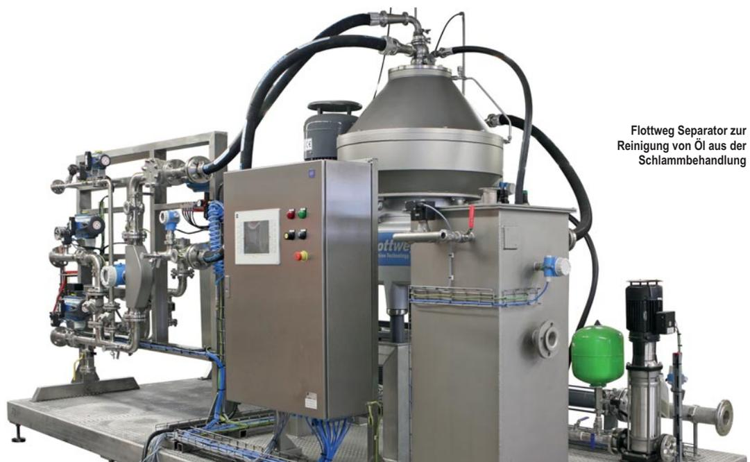
Flottweg Separator zur Reinigung von Öl aus der Schlammbehandlung
