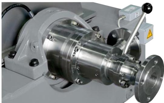
Zulauf und Ablauf-Vorrichtung mit Regler für die verstellbare Schälscheibe am Flottweg Tricanter®
