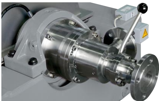
Levier de la turbine centripète réglable en marche sur le Tricanter® Flottweg
