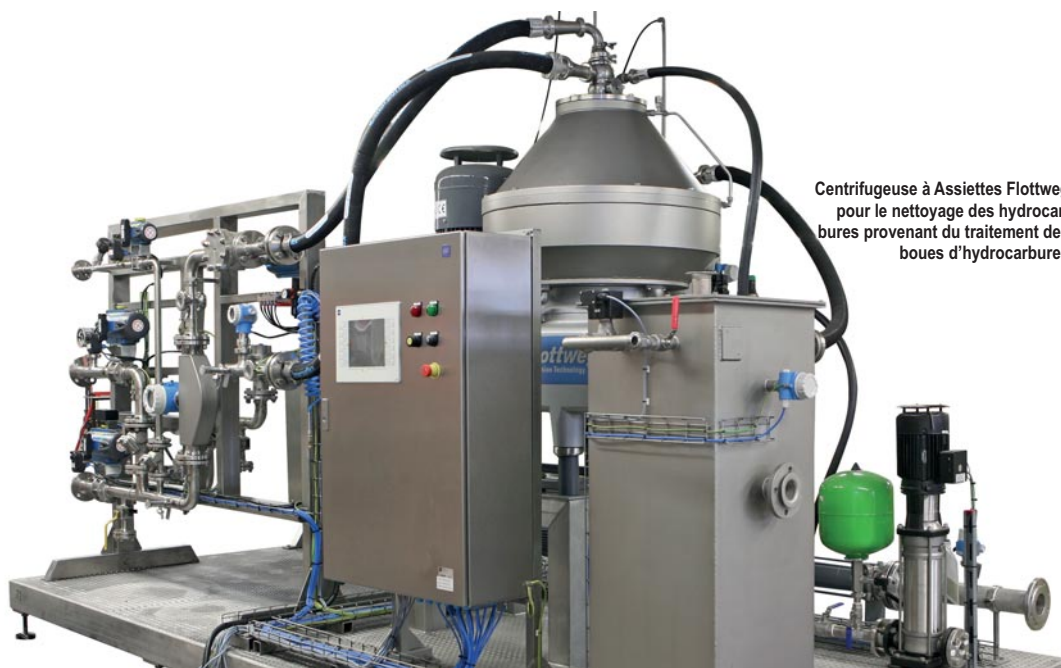
Traitement des boues d'hydrocarbures par le biais du Tricanter® et de la Centrifugeuse à Assiettes Flottweg
