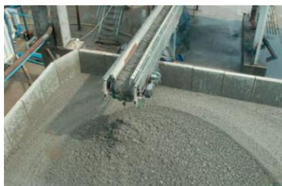
Descarga de Sólidos após processamento com Decanter Flottweg
