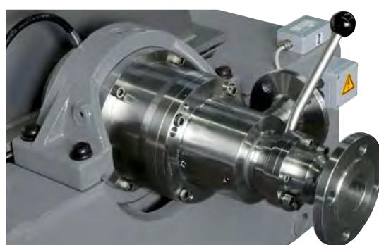
Механизм подачи и слива с использованием регулируемого импеллерного диска на Flottweg Tricanter®
