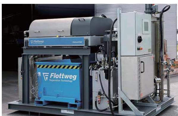
福乐伟三相卧螺沉降离心机®用于油污泥处理的撬装式结构
