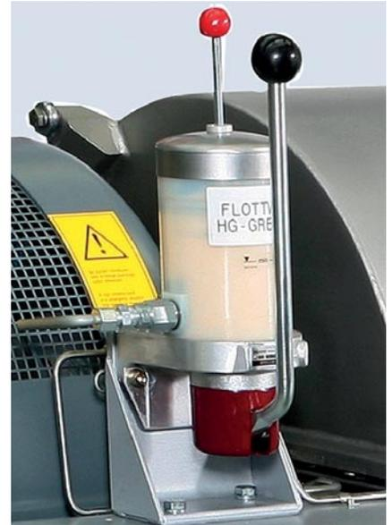
Système manuel de lubrification centralisé
