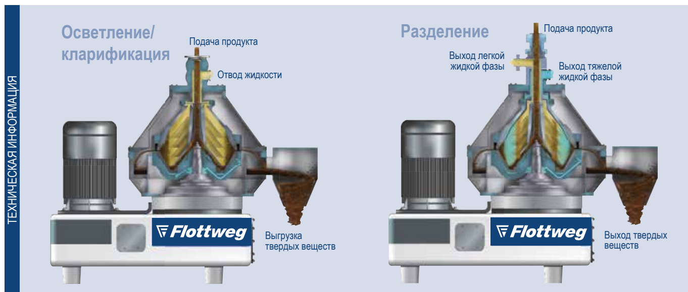
Тарельчатый сепаратор - кларификатор Flottweg для отделения твердых веществ от жидкостей
