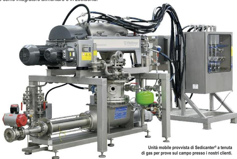
Unità mobile provvista di Sedicanter® a tenuta di gas per prove sul campo presso i nostri clienti.
