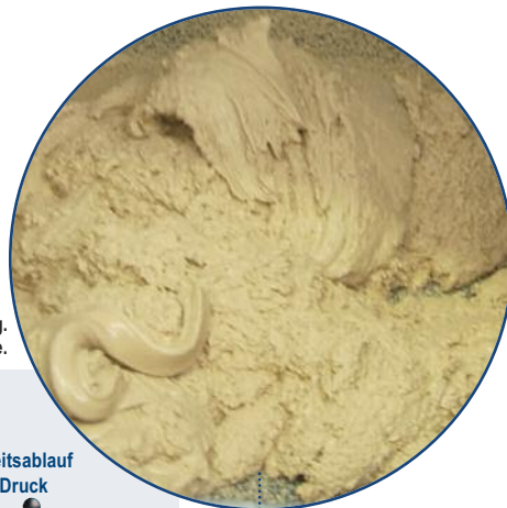
Anwendungsbeispiel Bierrückgewinnung. Hoher Trockenstoffgehalt in der abgetrennten Hefe.
