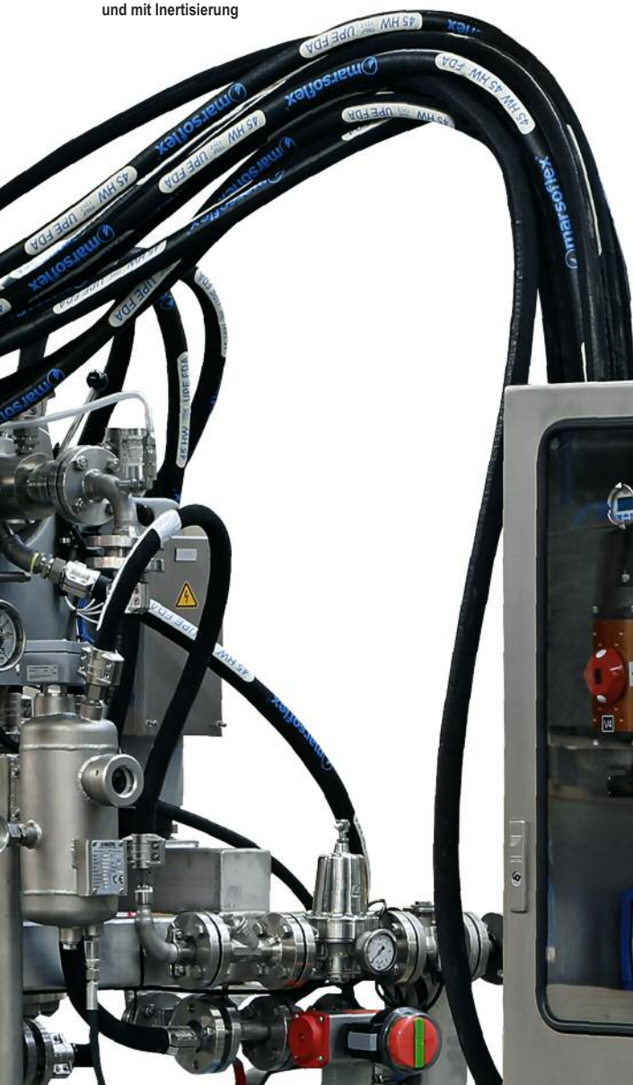
Mobile Versuchsanlage in Ex-Ausführung und mit Inertisierung
