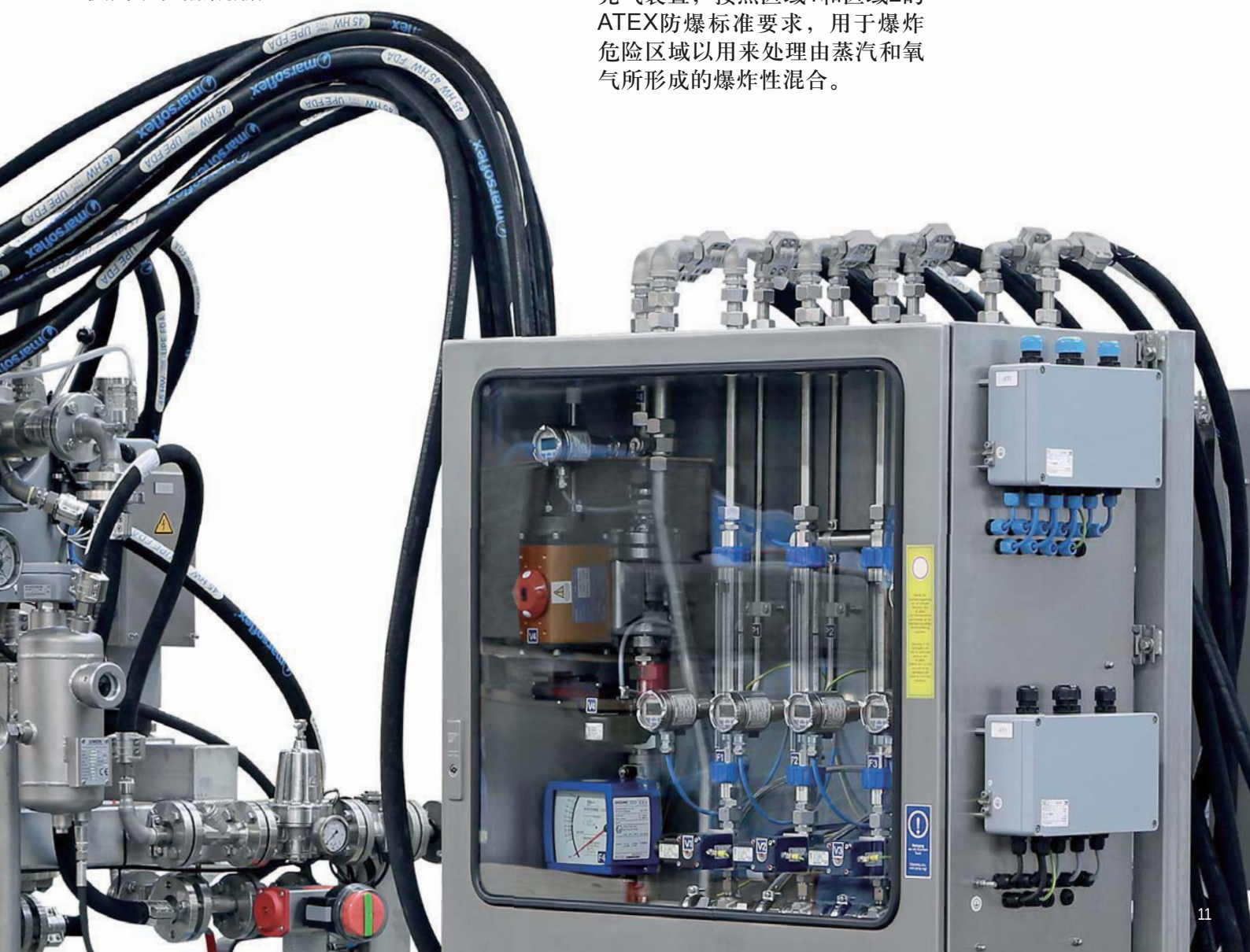
移动式试验机的防爆充气装置
