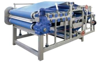
El perfil especial del rodillo y la guía de la cinta proporcionan esfuerzos de presión y cizalla alternos. De este modo, se garantiza una deshidratación rápida y eficaz.
