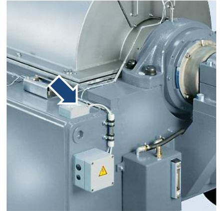
Contrôle des vibrations (standard)
